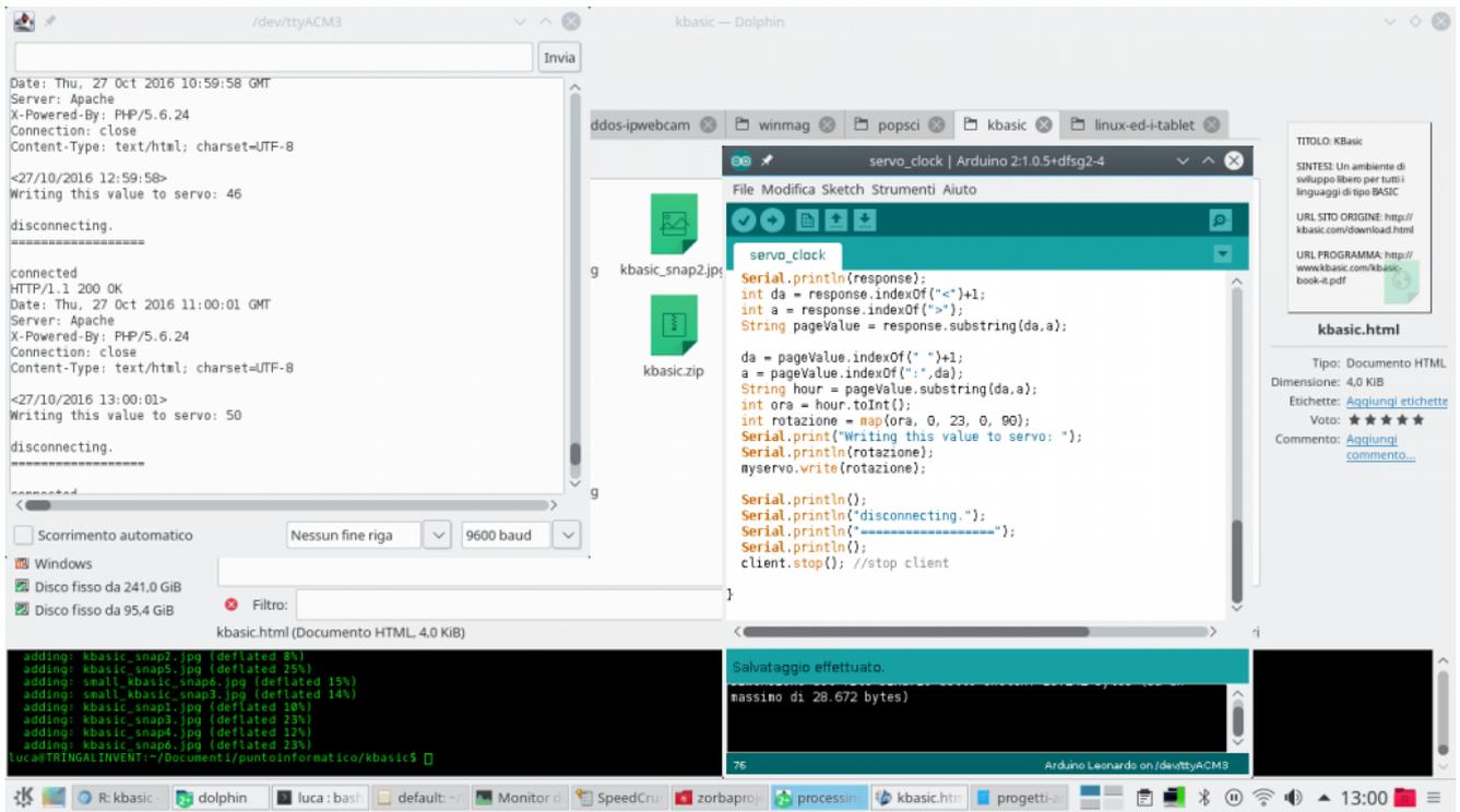
Con il monitor seriale di Arduino IDE possiamo leggere i messaggi che Arduino invia al nostro computer
