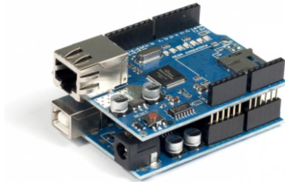
Una scheda Arduino Uno con lo shield ethernet montato sopra di essa
