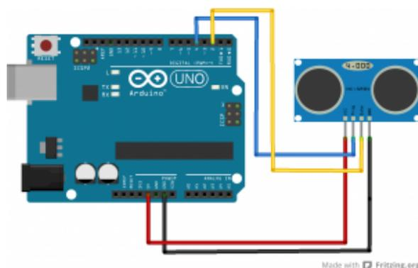
Il sensore di distanza HCSR04 ha 4 pin da collegare ad Arduino
