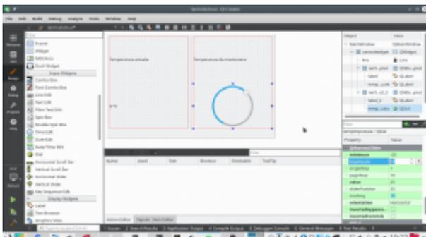
Cliccando col tasto destro sui vari oggetti, è possibile personalizzarne l'aspetto. Per esempio, può essere una buona idea dare alle etichette che conterranno le due temperature una formattazione del testo facilmente riconoscibile, con una dimensione del carattere molto grande.
