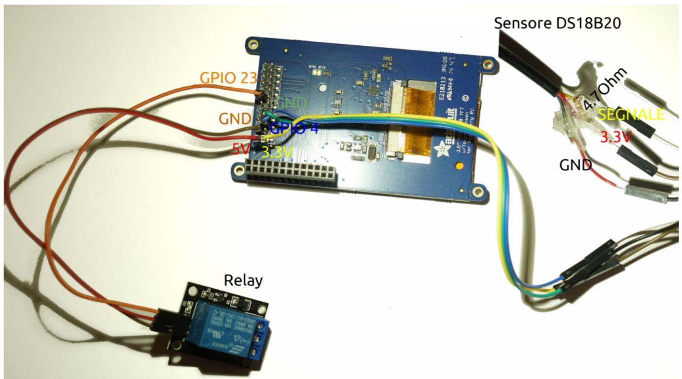
Ovviamente, un Raspberry offre molti pin, per collegare sensori e dispositivi, ma bisogna stare attenti a non usare lo stesso pin per due cose diverse. Per esempio, se stiamo usando il TFT da 3.5 pollici, possiamo verificare sul sito [pinout](#) che i contatti che usa sono il **18,24,25,7,8,9,10,11**. Rimane quindi perfettamente libero sul lato da 5Volt il pin 23, mentre sul
