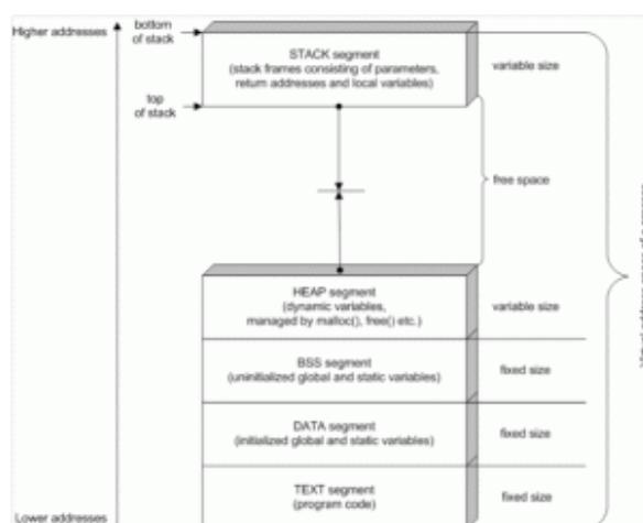
La segmentazione della memoria nei segmenti Text, Data, BSS, Heap, e Stack.
