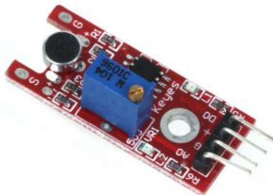
Il microfono KY-038 per Arduino
