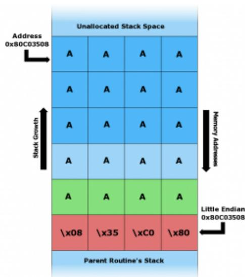
Durante la situazione di overflow, l'intero spazio dedicato alla variabile nello Stack è riempito dai byte della variabile stessa (nell'esempio il byte `\x41`, ovvero "A"). Il valore `\x41` va a sovrascrivere anche il byte nullo, il puntatore del frame di memoria, e l'indirizzo di ritorno della funzione.
